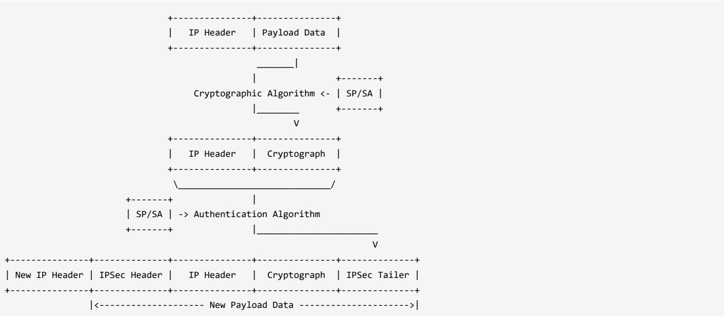
ESP的工作机制是先根据SP/SA中的加密算法，对包括上层协议在内的IP包数据载荷进行加密，然后根据SP/SA中的认证算法，对加密得到的密文连同IP包头计算消息摘要并签名，以形成包含认证数据在内的IPSec尾，连同包含加密信息在内的IPSec头一起作为数据载荷的一部分放入IP包。
