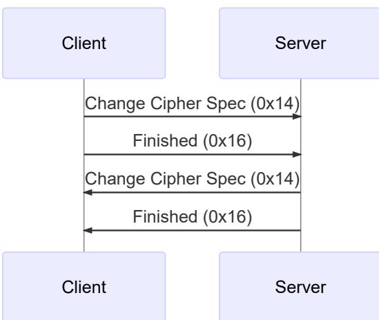
客户端和服务端分别向对方发送Change Cipher Spec和Finished类型的消息，告知对方SSL握手已经完成，双方的后续通信全部按照协商好的加密认证算法、数据压缩算法和密钥进行处理。
