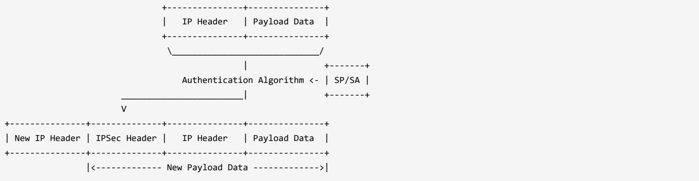
AH的工作机制就是根据SP/SA中的认证算法，对整个包括上层协议在内的IP包计算消息摘要并签名，以形成包含认证数据在内的IPSec头，作为数据载荷的一部分放入IP包。
