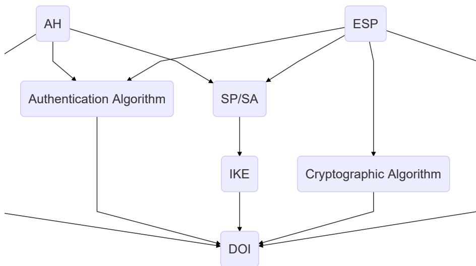
认证头(AH)和封装安全载荷(ESP)都是插入IP包数据载荷部分的协议头，为IP通信提供数据源认证、抗重播、数据完整性校验等安全服务。此外，封装安全载荷(ESP)还负责提供机密性服务。
