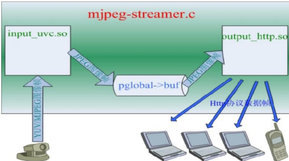
mjpg-streamer采用高聚低耦的架构模式，将输入插件和输出插件分离。其中，input\_testpicture.so插件用于从静态图片输入数据，而input\_uvc.so插件则用于从UVC摄像头输入数据。output\_http.so是个输出插件，用于将捕获到的视频帧画面，通过HTTP协议，输出给客户机。每次启动视频服务器，输入插件只能有一个，而输出插件则可以有多。
